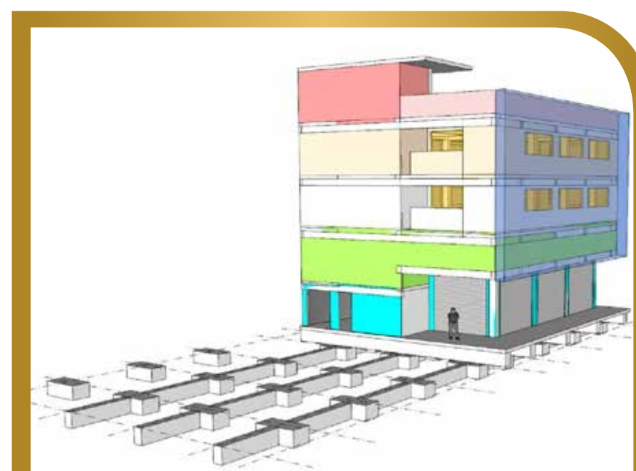
ตัวอย่างการเคลื่อนย้ายอาคาร 4 ชั้น น้ำหนักประมาณ 1,000 ตัน เลื่อนจากตำแหน่งเดิมออกไปประมาณ 20 เมตร เนื่องจากโดนเวนคืนที่ดิน
