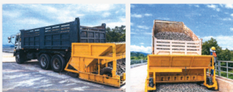
รถบรรทุกหินโรยทาง และ Ballast Box สำหรับขนและโรยหินชั้นแรก
