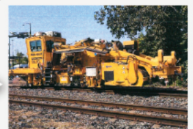
Ballast Regulator สำหรับเกลี่ยรูปทรง
