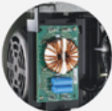
วงจรถ่ายสัญญาณควบคุม มอเตอร์จากแผงวงจรหลัก
