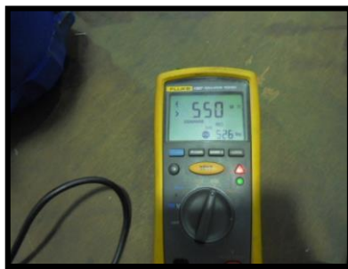
Fig 45. Insulation UI-G Test
