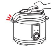
6. วางตัวควบคุมแรงดันบนช่องระบายลมและตรวจดูตัวบอกแรงดันแบบ POP-UP ให้อยู่ในตำแหน่งที่ถูกต้อง
