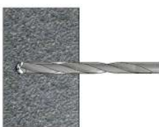
เจาะรูที่พื้น
