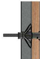
ขันสลักรูให้ปีกพุกขยายแล้วคลายสลักรูออก ติดตั้งวัตถุ พร้อมขันยึดให้แน่น
