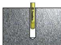
สอดฟุกิเคมีที่รูเจาะ โดยให้ด้านกลมอยู่ด้านล่าง
