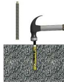
ตอกสตั๊ดฟุกิเคมีลงจนสุด แล้วค่อยๆทุบสตั๊ดอย่างช้าๆเพื่อให้น้ำยาผสมกับน้ำดีดีและเป็นการไล่ลมในรูคอนกรีต และในน้ำยาฟุกิเคมีแล้วขยี้ให้ แทนฟุกิเคมีให้อยู่ในจุดที่กำหนดรอให้ฟุกิเคมีแห้ง
