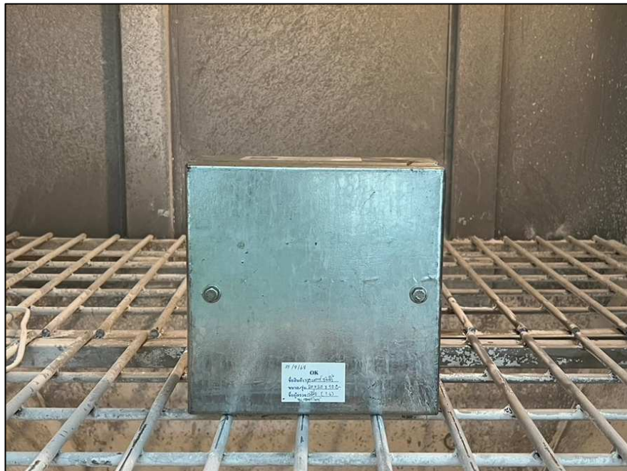
Photo No.4 : IP5X Dust test
