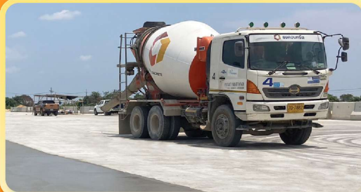
คอนกรีตผสมเสร็จ
